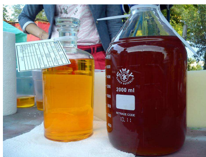
Slika 4. Transformatorsko ulje pre (desno) i nakon (levo) regeneracije
